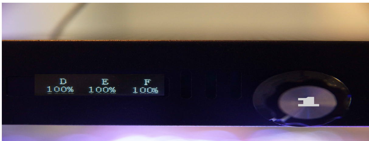
Abb. 7: Durch Drücken des Einstellknopfes wählt man die einzelnen Kanäle an und kann diese durch Drehen des Einstellknopfes verändern. Hält man den Einstellknopf danach länger gedrückt, wird der manuelle Modus wieder verlassen.
