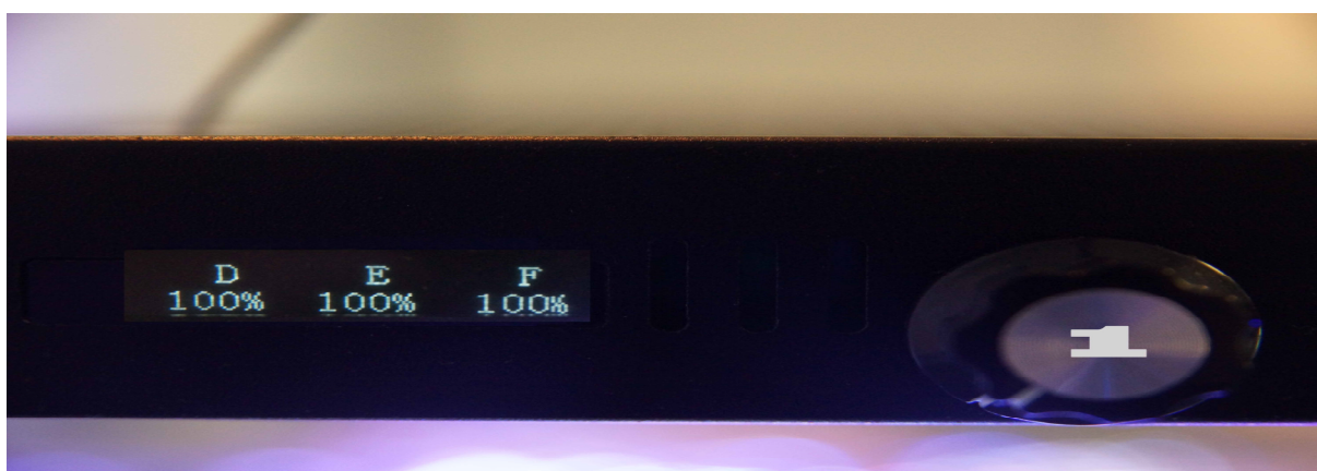
Рис. 7: Нажимая кнопку настройки и вращая её, Вы вызываете отдельные каналы и меняете их. Если Вы после этого подержите кнопку настройки дольше, то покинете режим ручной настройки.
