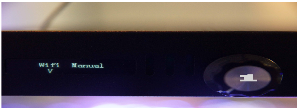
Рис. 4: Вращая кнопку настройки (1), можно переключаться с Wi-Fi на ручной режим.
