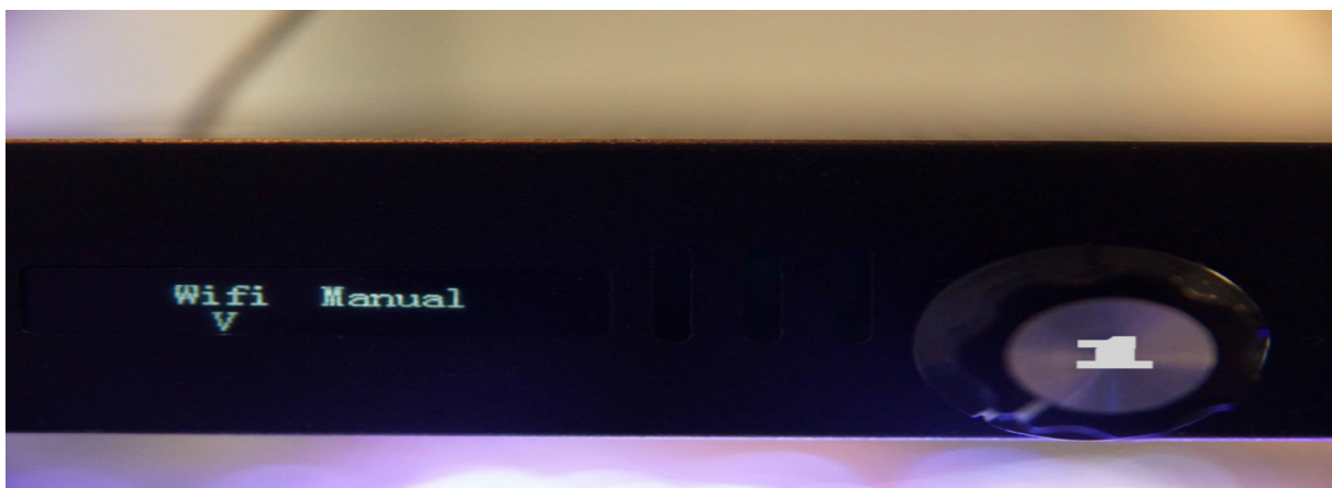
Fig. 4: Girando el botón de ajustado (1) puede cambiar entre Wifi y manual.
