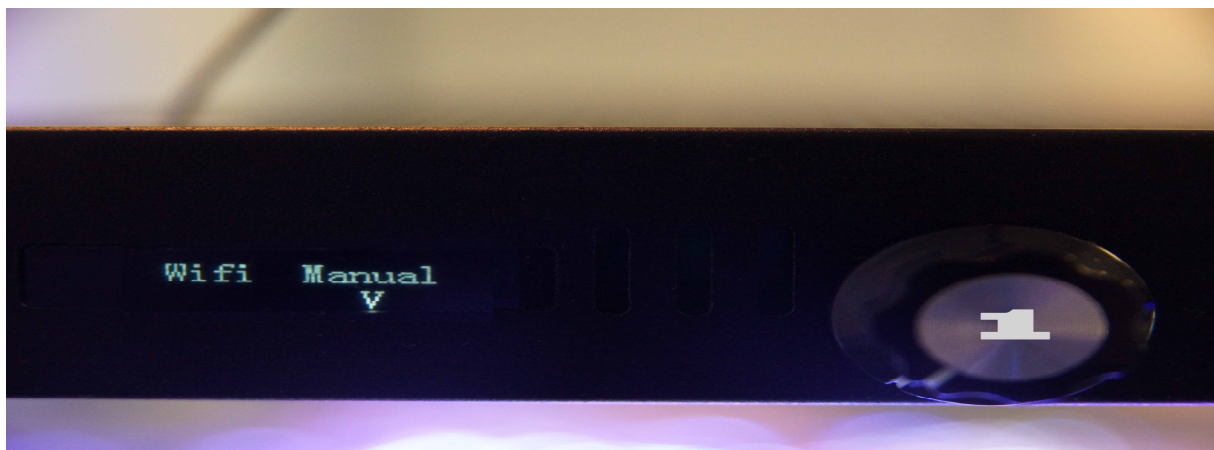
Abb. 6: Wählt man „Manual“ an und drückt den Einstellknopf, erreicht man die manuelle Einstellung.
