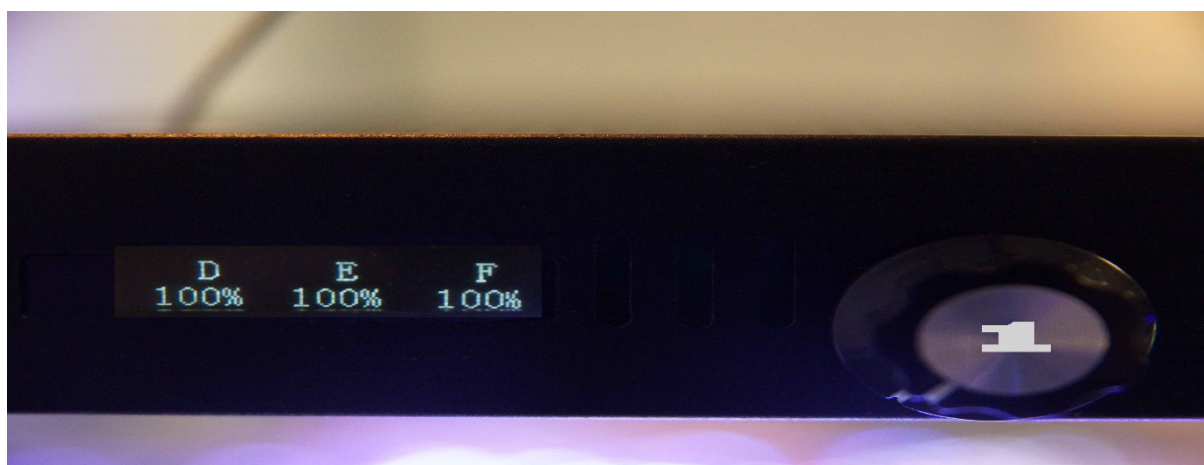
Photo 7: En appuyant sur le bouton de réglage on choisit les canaux individuellement et on peut les modifier en tournant le bouton de réglage. En maintenant la pression sur le bouton de réglage, on quitte le mode manuel.
