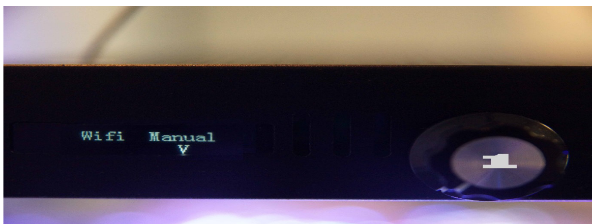
Photo 6: En sélectionnant „Manual“ et en appuyant sur le bouton de réglage, on atteint le réglage manuel.
