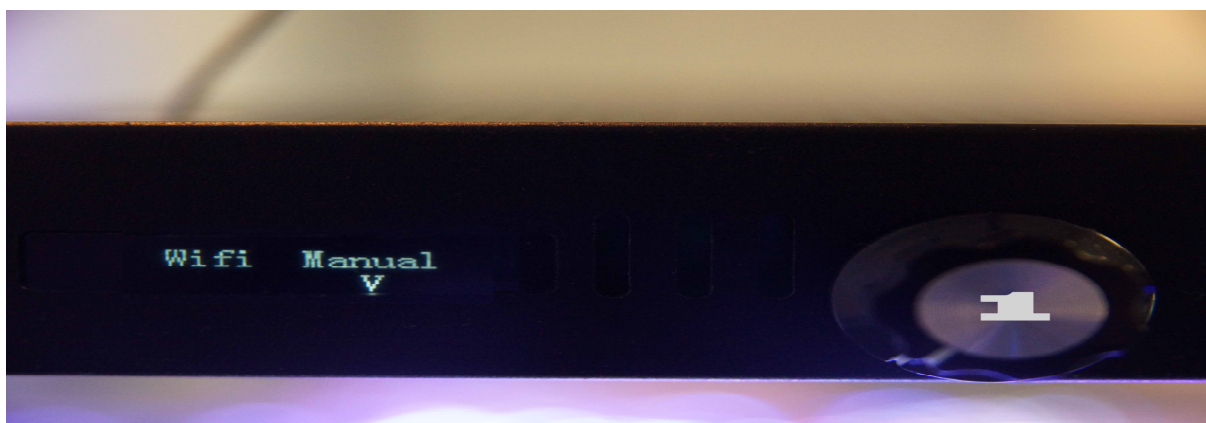
Рис. 6: Если Вы выбираете программу „Manual“ и нажимаете на кнопку настройки, то в данном случае Вы выходите на ручную настройку.
