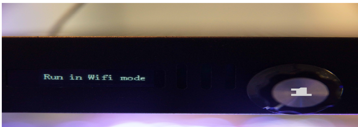
Рис. 5: После быстрого нажатия на кнопку настройки (1) появляется сигнал „Run in Wifi mode“.
