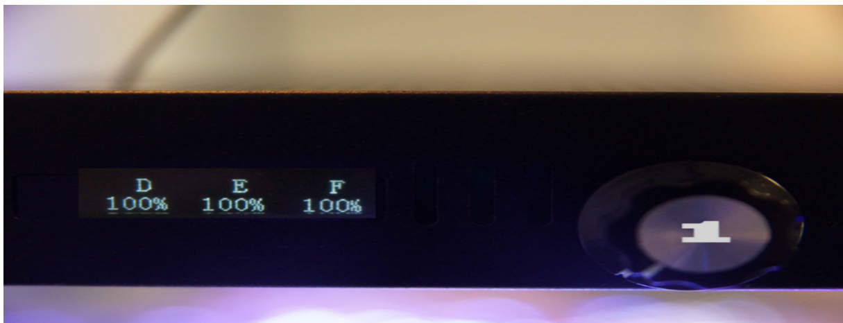
Fig. 7: Presionando el botón de ajuste, los canales individuales pueden ser seleccionados y podemos cambiarlos girando el botón de ajuste. Si mantiene el botón presionado más tiempo, se deja el modo manual de nuevo.
