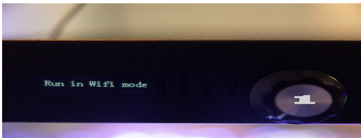
Photo 5: Après une courte pression sur le bouton de réglage (1) apparaît (Run in Wifi mode). Il est maintenant possible de commander et de régler la lampe par App. Une nouvelle pression permet d'atteindre le choix entre Wi-Fi et manuel.
