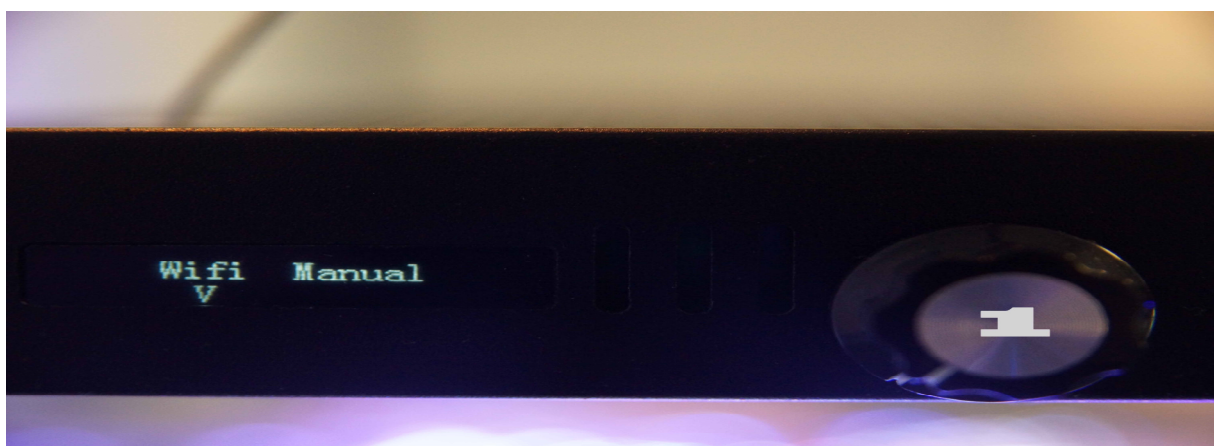
Abb. 4: Durch Drehen des Einstellknopfes (1) kann zwischen Wi-Fi und manuell umgeschaltet werden.
